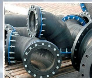
Резиноктаневые трубопроводы (пульпопроводы) – альтернатива металлическим трубопроводам, так как срок службы резиноктаневых пульпопроводов превышает срок службы металлических. Применяются для транспортировки материалов в тяжелых условиях эксплуатации гидравлическими системами: добыча полезных ископаемых, дноуглубительные работы, намыв песка и пр.
